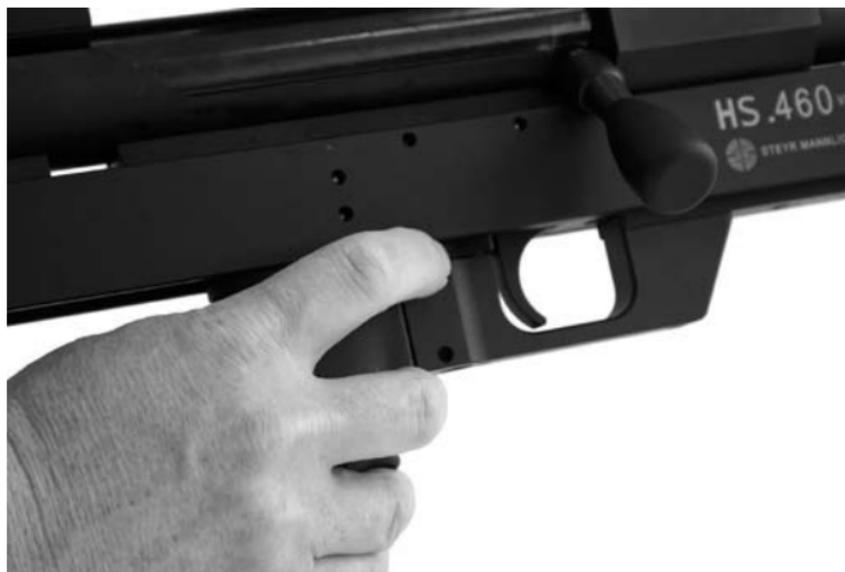
Sichern Sie die Waffe durch Zurückdrehen des Sicherheitsrades mit dem Zeigefinger – der rote Punkt ist nicht mehr sichtbar.
