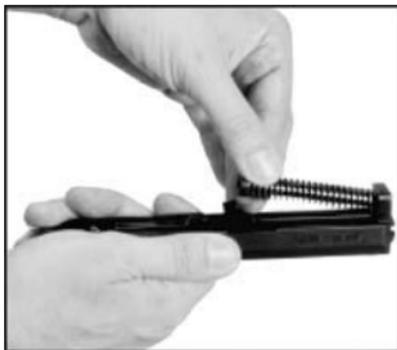
Lauf am Verriegelungsblock fassen, anheben und nach hinten/oben aus dem Verschlussstück ziehen.
