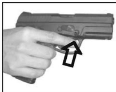
Die Schussauslösung erfolgt, indem der Abzugfinger außerhalb des Abzugsbereiches die vor dem Abzug befindliche manuelle Sicherung aufwärts gedrückt, diese damit deaktiviert ist und der Abzug, wie beim Sicherungszustand 1, in seine hinterste Position gebracht wird.
