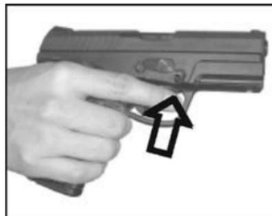
Die Schussauslösung erfolgt, indem der Abzugfinger außerhalb des Abzugsbereiches die vor dem Abzug befindliche manuelle Sicherung aufwärts gedrückt, diese damit deaktiviert ist und der Abzug, wie beim Sicherungszustand 1, in seine hinterste Position gebracht wird.
