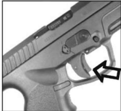
Der Ladestandsanzeiger tritt sichtbar und fühlbar aus dem Verschlussstück.
