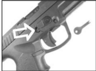
Die Wirkung der Schlüssel- Funktionssperre wird aufgehoben, indem der in die Öffnungen eingeführte Schlüssel mittels Druckausübung und Sperrbewegung in Richtung des auf dem Griffstück ersichtlichen Buchstaben „F“ (Fire) gebracht wird.
