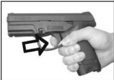
Schlüssel- Funktionssperre mit dem Daumen der Schusshand niederdrücken, gedrückt halten. Zerlegehebel abwärts schwenken. Verschlussstück nach vorne vom Griffstück abziehen.
