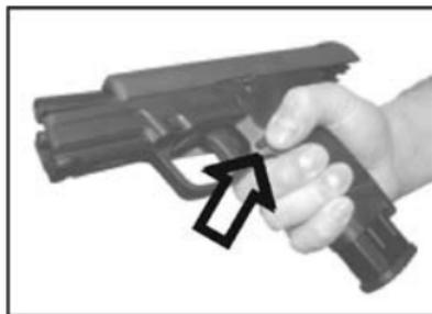
Das neue Magazin, wie bereits beschrieben, einführen und entweder den Verschlussfang nach unten drücken und damit das Verschlussstück in die Ausgangsstellung vorschnellen lassen
